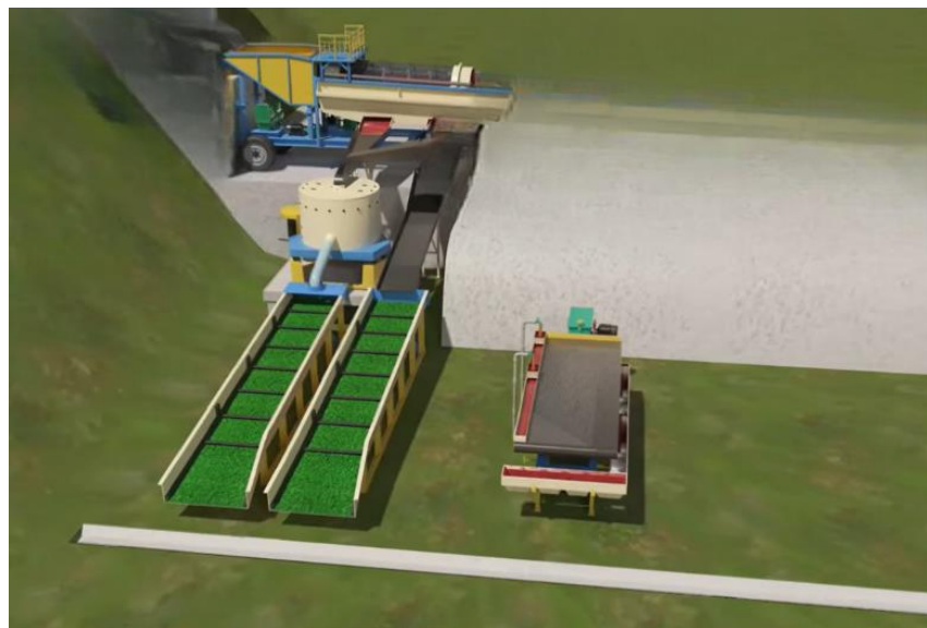
Img. 10 – Esquema tecnológica: Trommel → Concentradora → Canaletas → Mesa vibratoria
